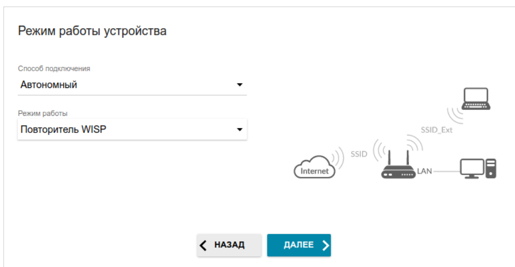
Рисунок 35. Выбор режима работы устройства. Режим Повторитель WISP .
