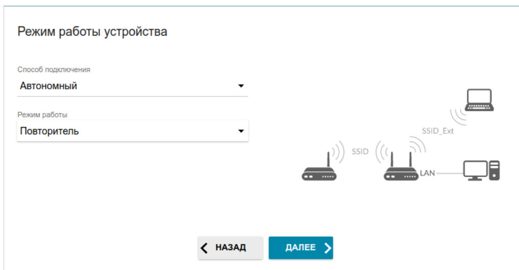
Рисунок 37. Выбор режима работы устройства. Режим Повторитель.
