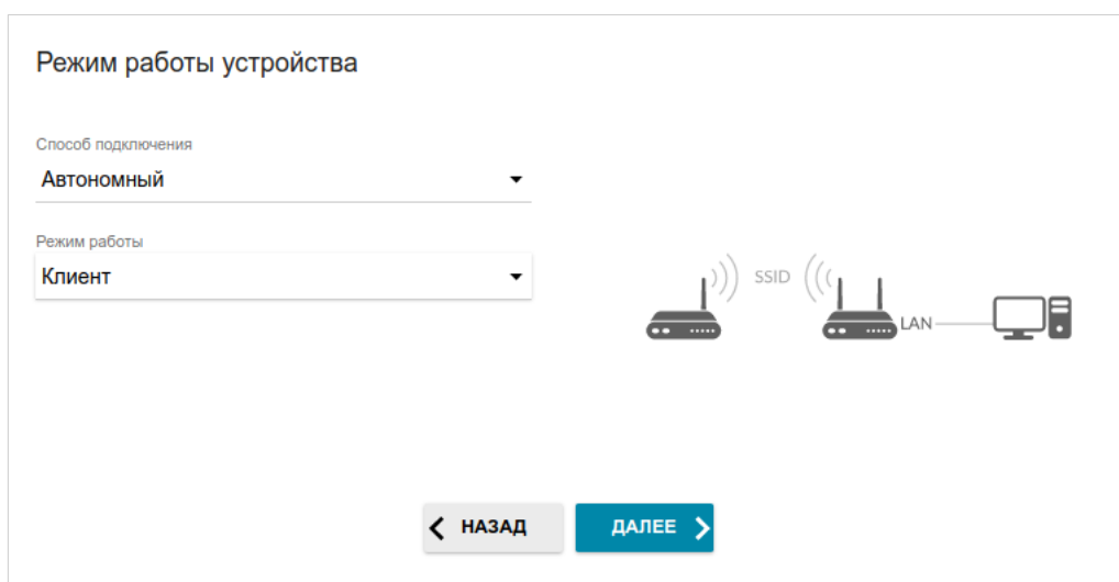
Рисунок 38. Выбор режима работы устройства. Режим Клиент .
