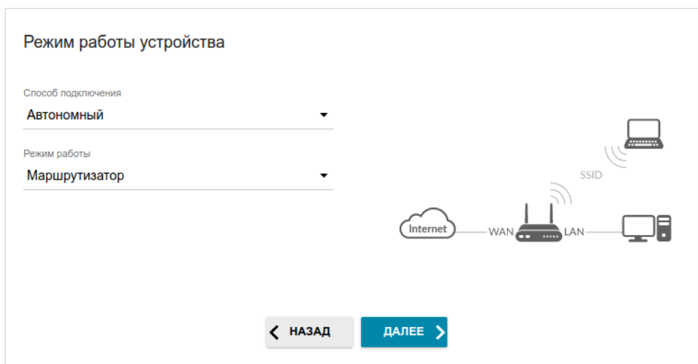
Рисунок 33. Выбор режима работы устройства. Режим Маршрутизатор .
